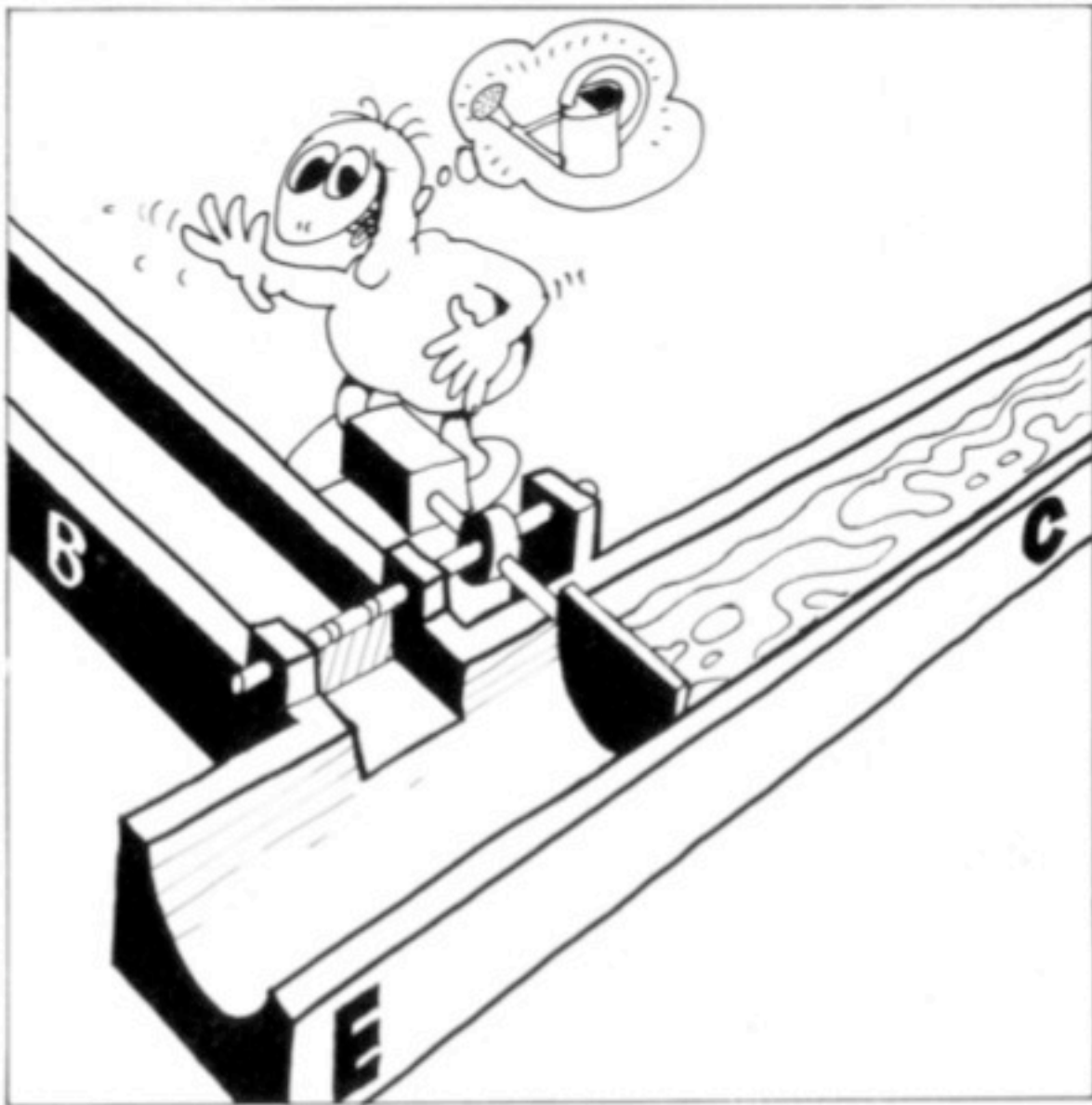
Bild 60. „Wasser-Transistor“ (gesperrter Zustand)
